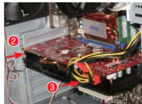
⚠ 補助電源コネクタの6ピン又は6ピン×2が必要な場合があります。構成されている電源により準備されているコネクタの仕様が変わります。
