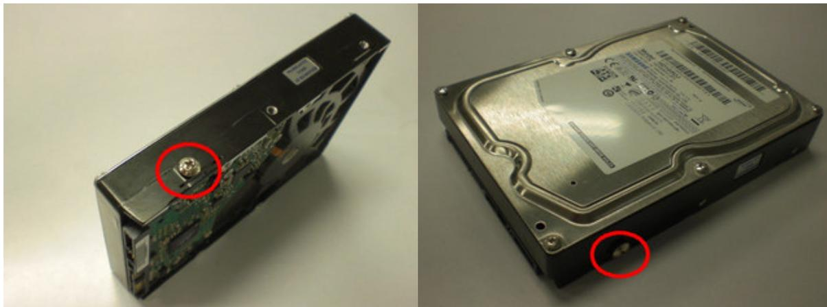
外したハードディスクの右側面に取り付けられている、インチネジを外し、交換予定のハードディスクに取り付けて下さい。
