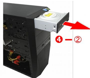
⑤ 新しい「光学ドライブ」に換装するときは手順 ④ ~ 手順①の順に作業します。
