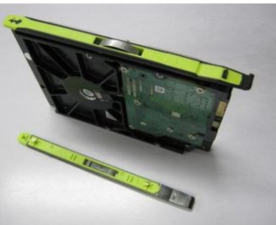
取付の際には、ドライブ側面のネジ穴に、レールの突起をあわせ、上記のように、ハードディスクのコネクタ側に、レールの持ち手部分を向け、取り付けを行います。
