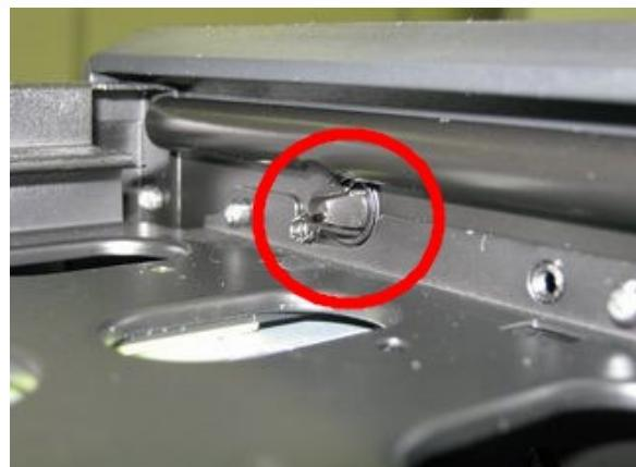
赤枠部分に、レールストレージボックスが取り付けられています。
