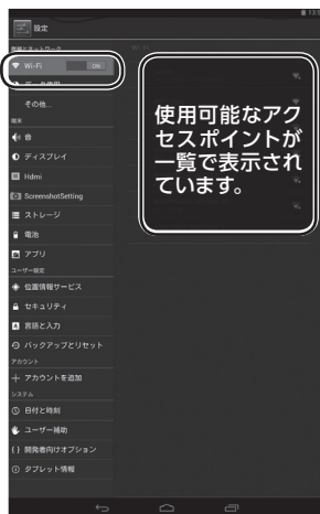
2. 設定項目よりWi-Fi をONにする。しばらくして接続可能なアクセスポイントが一覧表示されるので、使用する項目を選択する。
